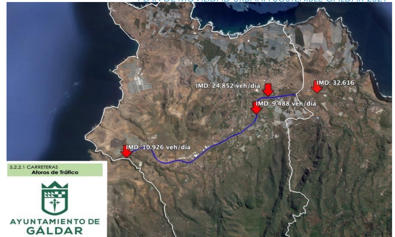
Imagen 10. Aforos en la Autovía GC-2 Elaboración propia. Fuente: Google Earth.
